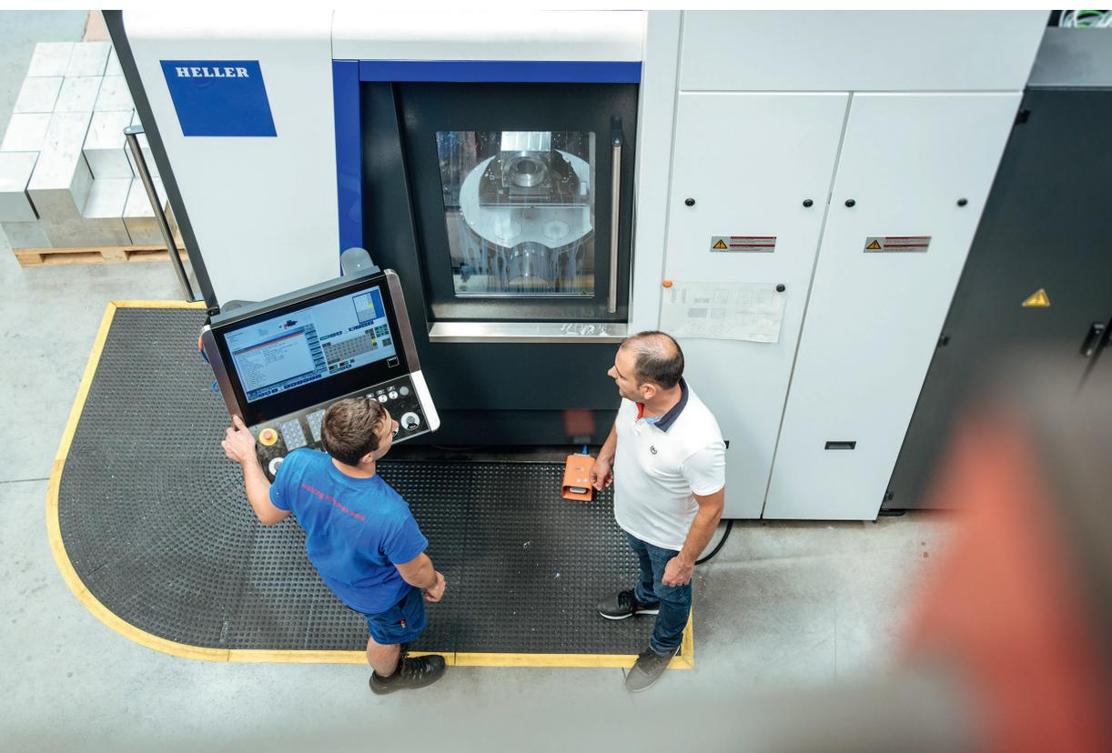
1 Das auf Universalität ausgelegte Maschinenkonzept des horizontalen 5-Achs-BAZ HF 3500 von Heller sowie die neu entwickelte Bedienoberfläche, die auf einem 24"-Touch-Bildschirm der Siemens-Steuerung läuft, haben Fematec überzeugt (© Heller)
